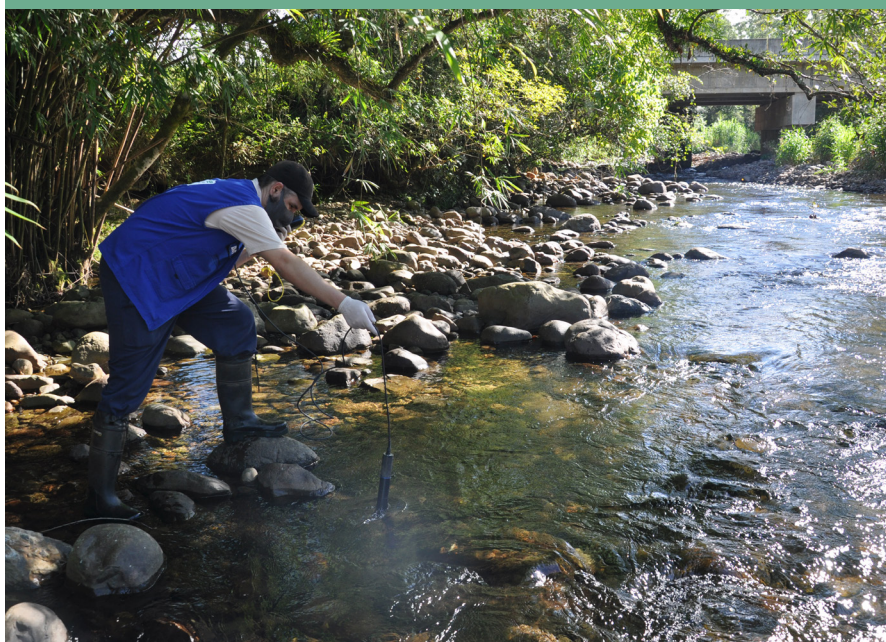
Sonda realiza a medição imediata de parâmetros como temperatura, oxigênio dissolvido, pH e turbidez
