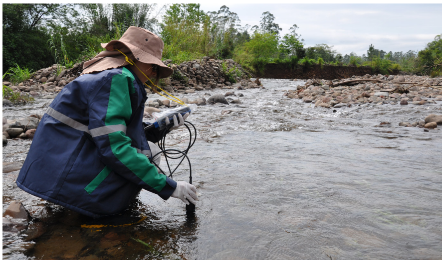
Com o auxílio de uma sonda Aquaread AP 800, a equipe consegue medir diversos parâmetros em campo
