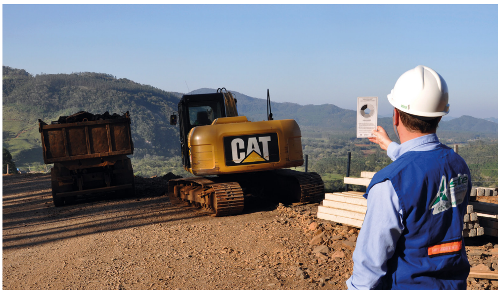
Técnico da Gestora Ambiental monitora a emissão de fumaça com o uso da escala de Ringelmann
