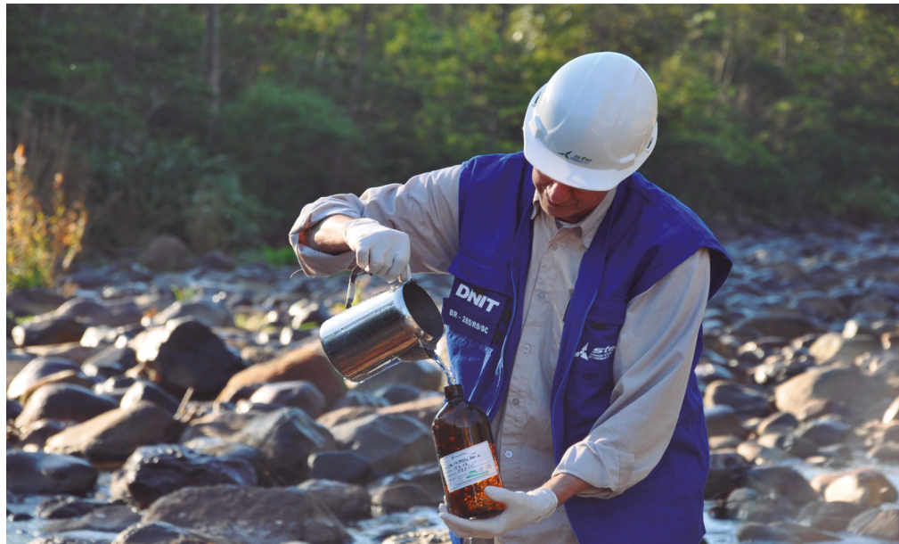
Equipe coleta amostras de água para verificar se as obras estão causando impactos negativos aos recursos hídricos
